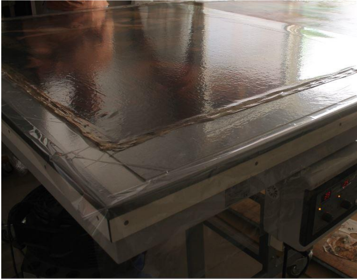
Prasowanie obrazu na stole niskociśnieniowym.
