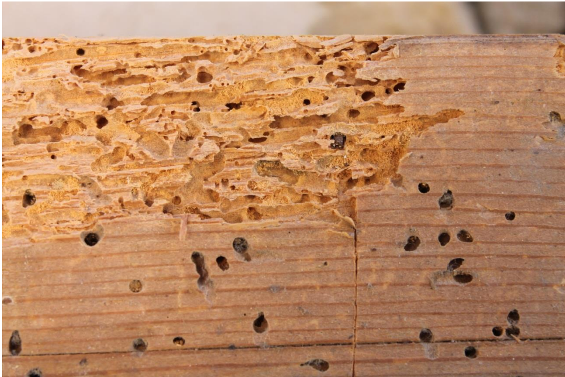
Fragment żerowiska z widocznymi korytarzami i produktami przemiany materii owadów w formie jasnej „mączki”.
